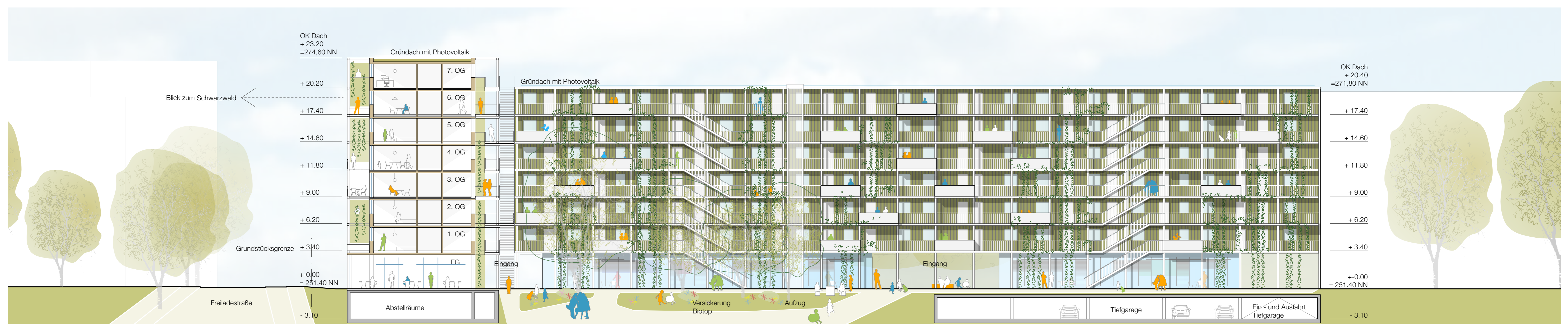
Schnitt Freiladestraße - Ansicht Laubengängerschließung 1:200
