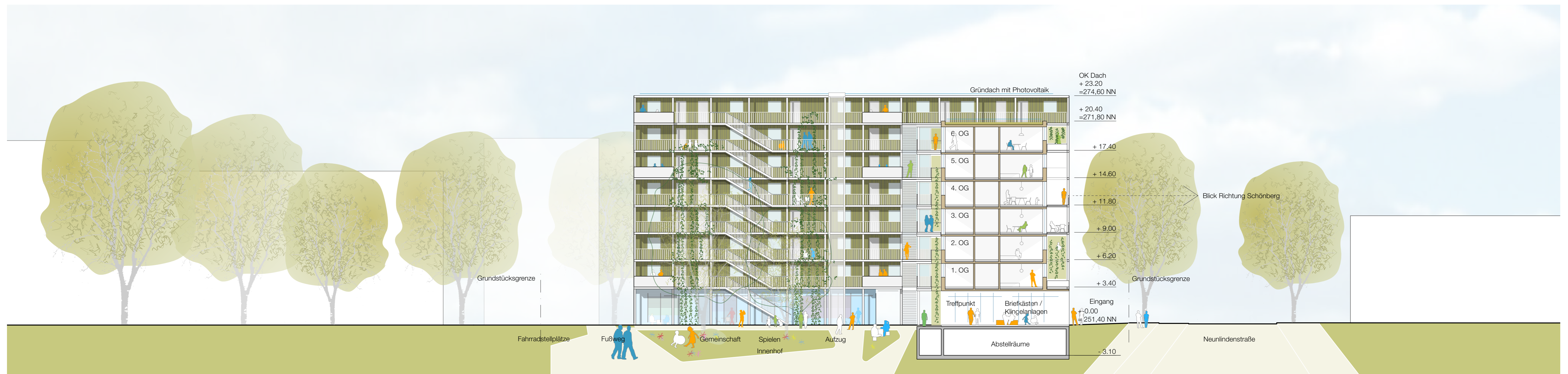
Schnitt Neunlindenstraße - Ansicht Laubengängerschließung 1:200
